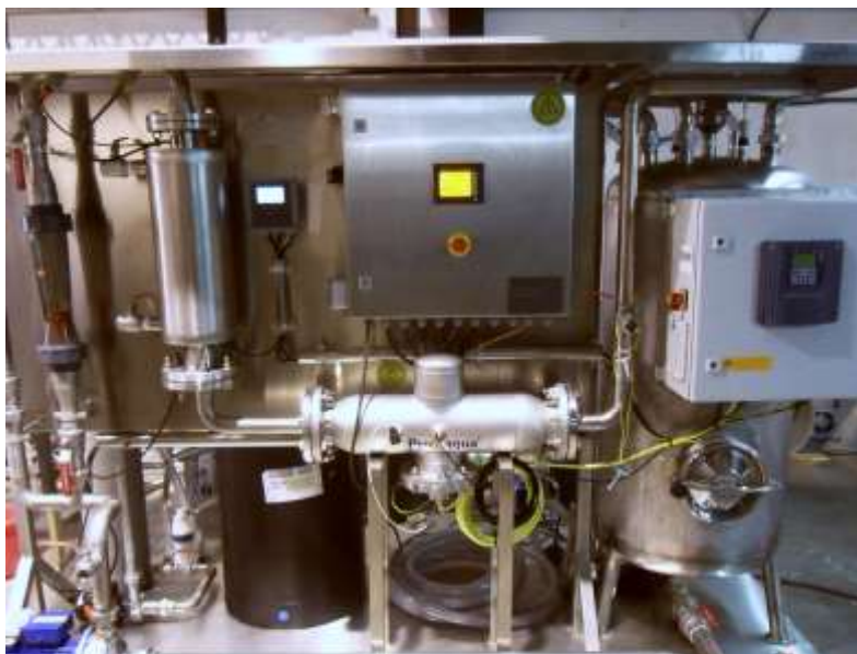
Oxidación catalítica (Procesos de oxidación avanzada) Generación de radicales hidroxilo mediante catálisis homogénea y heterogénea Catalytic oxidation (Advanced oxidation Processes) Hydroxyl radical generation by homogeneous and heterogeneous catalysis
